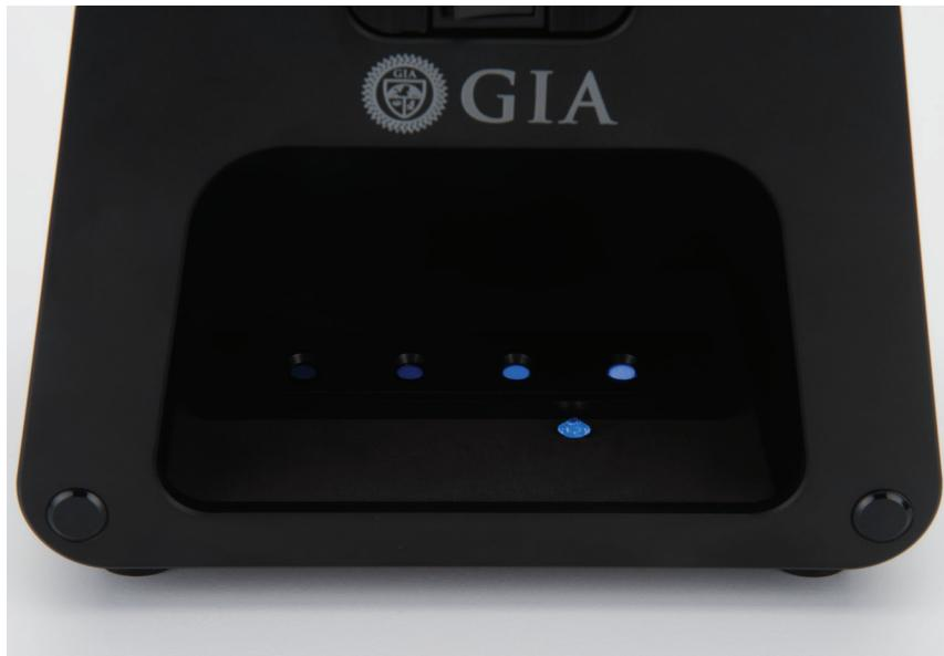
GIA 紫外灯和观察箱中的 LED 光源设计具有较宽的辐射角度加上相对稳定的强度释放，故其照明能够扩及整个观察箱内区域。我们建议您将宝石放在靠近观察箱中心的位置，以处于最便于荧光观察的状态，但是如果您要在观察箱内观察许多宝石，应将这些宝石以类似的方式逐一曝光在紫外线下。
