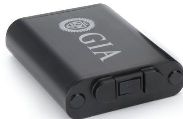
GIA 紫外灯和观察箱的最大优势之一是，将窄带 365 nm 紫外 LED 作为光源。市场上销售的大多数紫外灯都是汞灯搭配能控制紫外线发射能量的消耗性过滤器。过滤器允许发射出额外的紫外线和可见光（随标准的 365 nm 长波紫外线一起发出），且质量损耗相对快速而将造成更严重的光污染。此外，365 nm 的紫外线发射往往非常宽，通常包含 340-390 nm 的能量范围。光污染和不同波长的紫外线发射导致钻石产生的荧光在颜色和强度方面会有所不同。GIA 紫外灯和观察箱中包含 365 nm 紫外 LED，能够单独发射 365 nm 的紫外线，光线 FWHM（半峰全宽）为 9 nm。这种窄带发射可提供精确、可重复的紫外光源，便于一致地观察钻石荧光。此外，紫外 LED 寿命非常长，估计为 60,000 小时。
