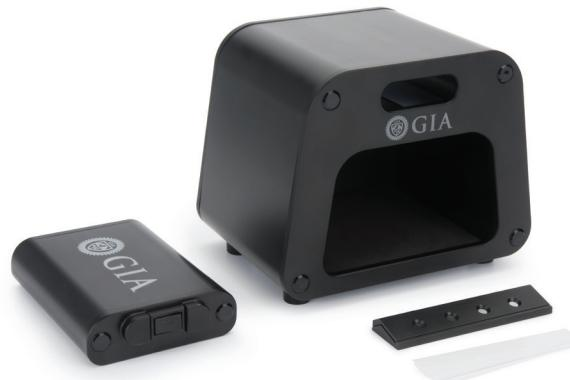
GIA 紫外灯和观察箱有四个主要零部件：观察箱、可拆卸紫外灯、电源供应器和比色块。要开始使用，请选择适合您所在地区的插头适配器，然后连接至电源供应器。然后将电源供应器线连接至紫外灯背面的插口（在观察箱内），并将另一端连接至运作正常的电源插座。要打开紫外灯，只需将设备前面的电源开关拨到 ON（开）位置。开关上的红色 LED 将亮起，紫外灯将在观察箱内发出紫外线。
